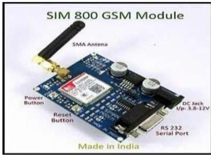
Fig.6: GSM module
